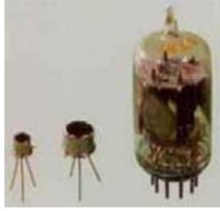
ขนาดของวงจรทรานซิสเตอร์เมื่อเทียบกับหลอดสุญญากาศ
