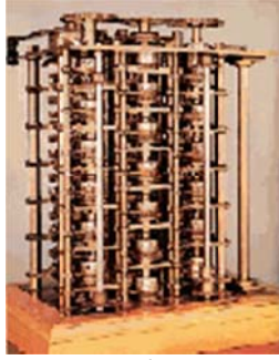
ดิฟเฟอเรนซ์เชียลเอนจินที่คิดค้นโดยชาร์ล แบบเบจ
