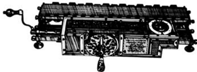
เครื่องคำนวณสเต็ป เรคคองเนอร์ของกอดฟริด ฟอน ไลบ์นิซ
